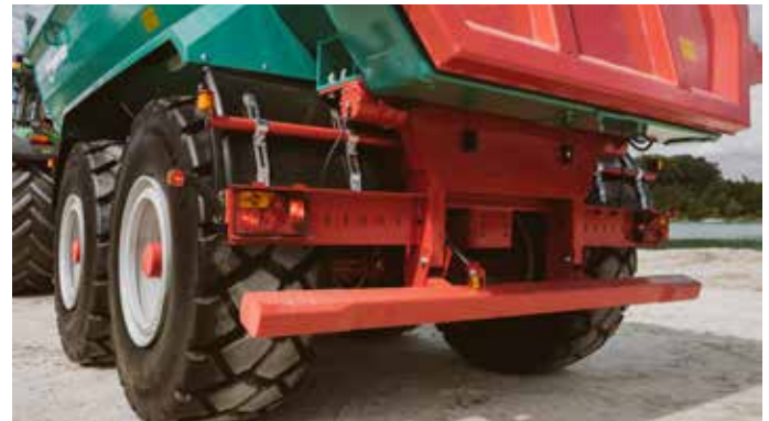
Pendelachse mit Zentralbolzenlagerung
