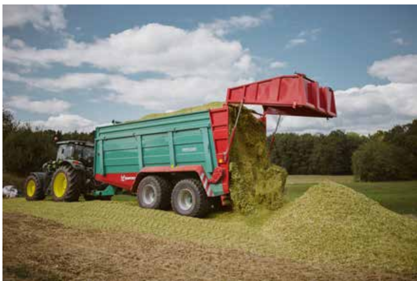
Integrierte Silageklappe in der Abschiebewand
