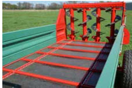
Hochfeste Rundstahlketten 8x31 mm
