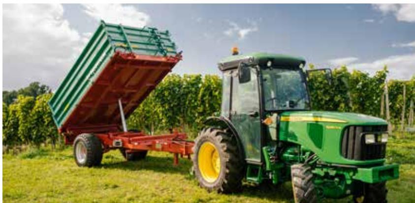
Standstabilität durch großzügige Spurweite (1700 mm)
