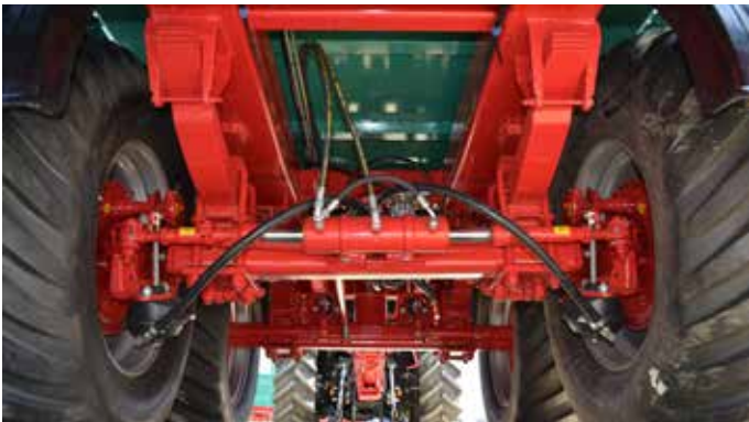
Parabelfederung mit Pendelachs-Aggregat
