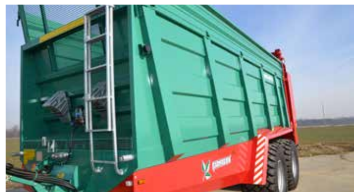
U-Rahmenprofil 190 mm für größte Stabilität
