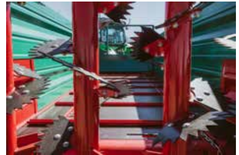
Fräsmesser aus HARDOX®-Stahl
