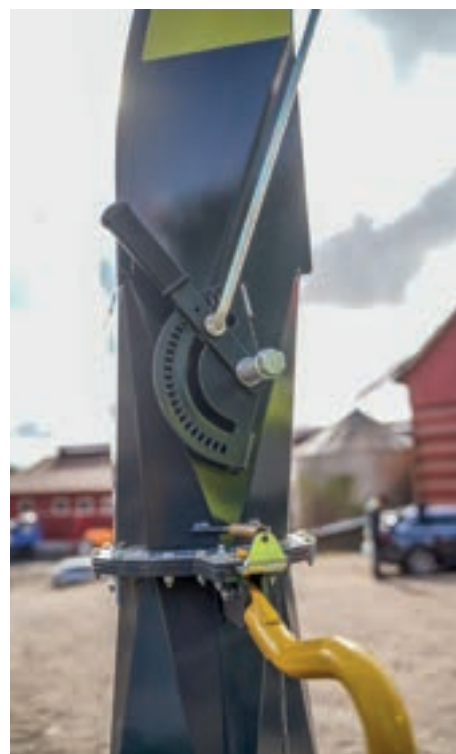
mech. Neigungsverstellung des Auswurfrohres
