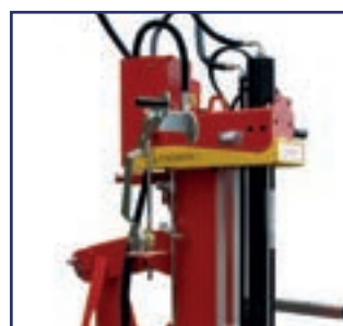
Zylinder absenkbar in „Transportposition“
