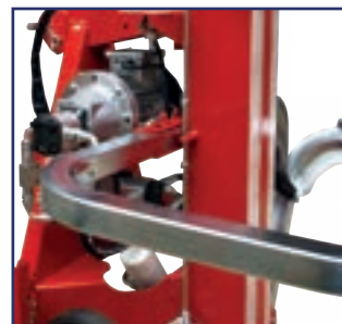
Kombiantrieb: Zapfwellenantrieb + Elektromotor.
