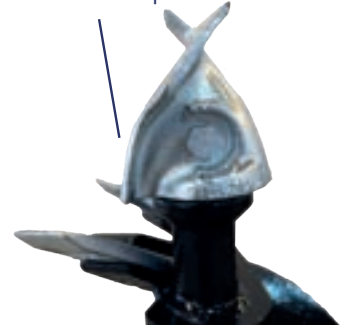
Wechselbare Spitze für Erdbohrer
