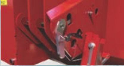
Unterenkerbolzen mit patentiertem Sicherungssystem ohne Stecksplinte
