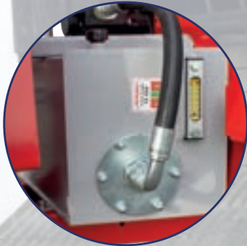
Öltank mit Schauglas inkl. Saugfilter
