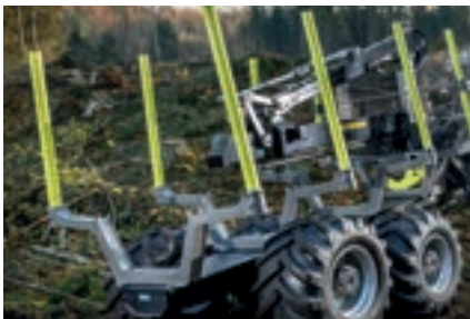
Mechanischer Antrieb über die Zapfwelle vom Traktor oder Hydraulisch
