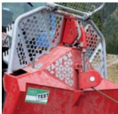
Die serienmäßige Umlenkrolle lässt sich bei Nichtgebrauch magnetisch am Rückeschild fixieren.
