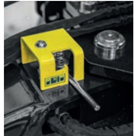
Deichsel Verriegelung - Auto-Lock
