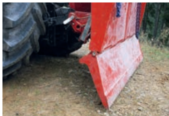
Das 2,02 m breite Rückeschild lässt sich hydraulisch schwenken.
