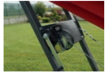
einfache Höhenverstellung mittels Seilwinde
