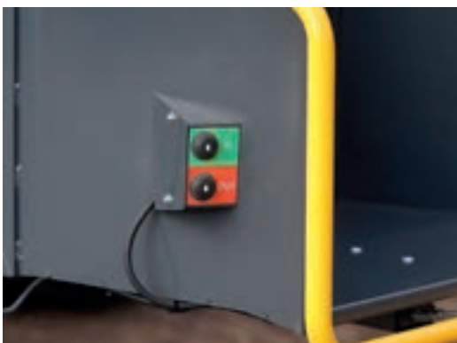
Elektrische Steuerung der Einzugswalzen
