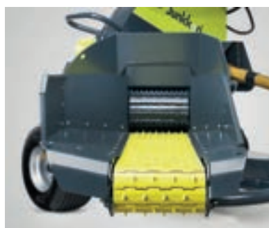
HJ-500 mit dem Förderband. Die Länge des Förderbandes beträgt 150 cm und der Hacker eignet sich dadurch noch besser zur Verarbeitung von Holzresten.
