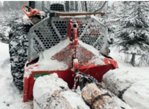
Auch unter härtesten Einsatzbedingungen machte die Winde eine gute Figur. Ist das Seil aber vereist, lässt es sich nicht mehr ausspulen.
